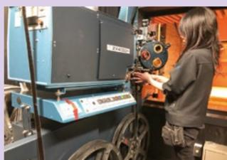
映像が写ったフィルムを映写機にセットした後方から光をあてる事でスクリーンへ拡大、投影します。映像以外に音声情報もあり映写機に搭載されている音声認識装置で読み取り出します。フィルムは約20分で構成されており2時間の映画だと6巻程度のフィルムを2台の映写機で手動切替する方法と、専用アルミ箔を少量貼り電氣的に自動切替する方法があります。
