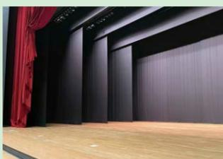
舞台両袖を隠すための幕です。舞台の左右方向を表す上手・下手の対で設置され、袖の中にある大道具や待機している出演者が見切れないようにするための役割をもっています。開いている状態では袖幕と同じ機能を持ち、中央まで閉じることで、舞台奥行き方向を仕切ることが出来る「引割幕・中割幕」も存在します。
